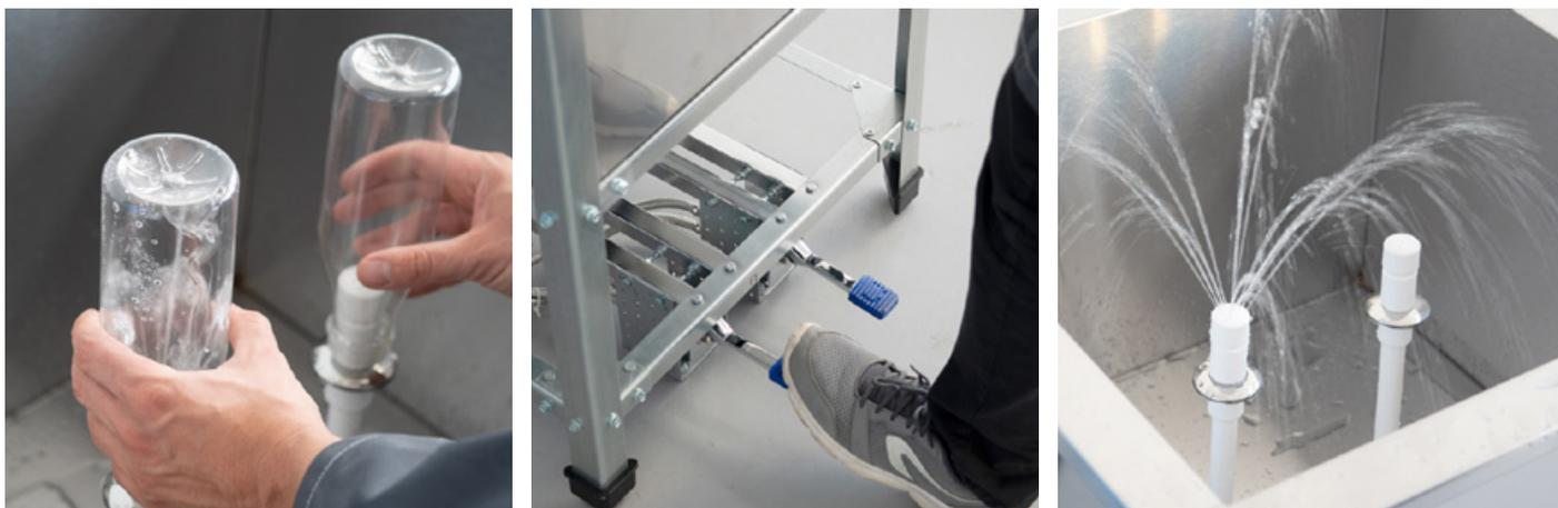
Устройство представляет из себя односекционную мойку с двумя моющими форсунками.
