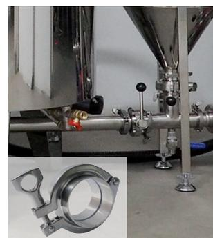
• Трубопроводный контур на быстроразъемных соединениях с комплектом запорной арматуры
