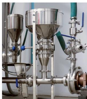
• Загрузочная воронка для удобной загрузки и предотвращения «забивания» трубопроводов
