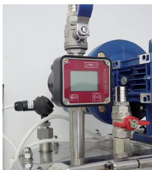
• Счетчик загрузки жидких компонентов
